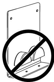
**IMPORTANT : NE PAS** retirer les butées d'arrêt de caoutchouc de la plaque d'aluminium, cela pourrait endommager la borne de recharge.
