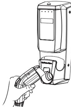
2. Brancher le connecteur de recharge au véhicule.
