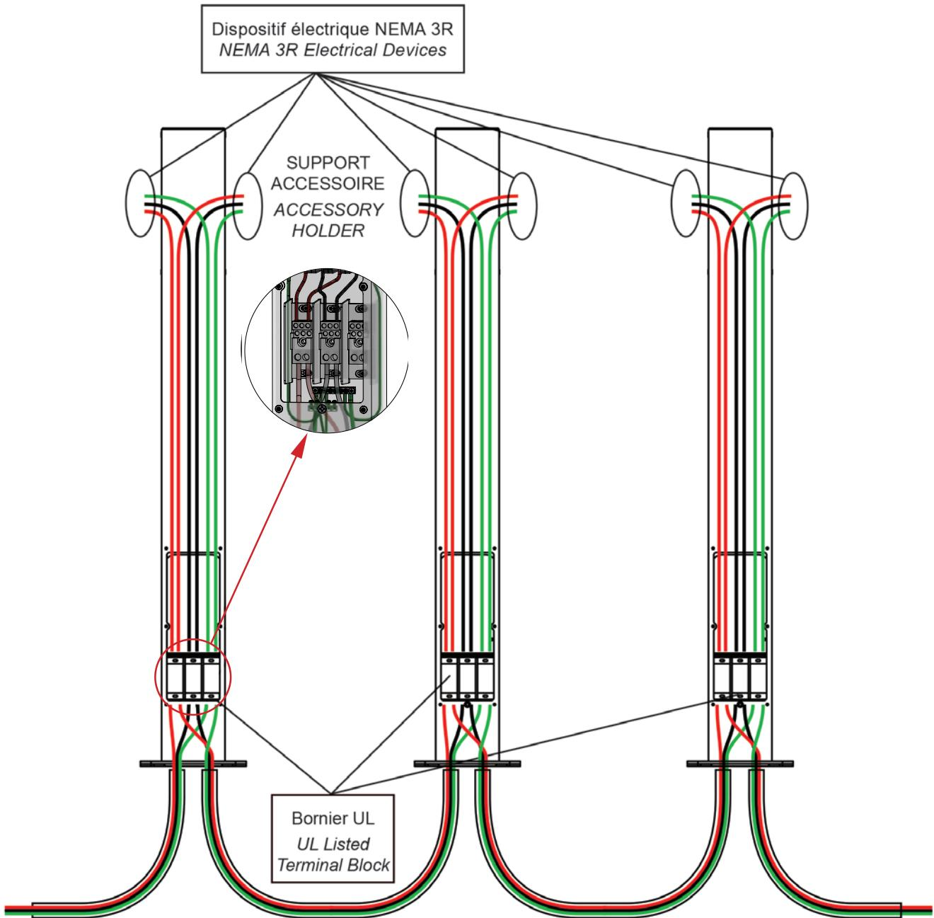
Multiples piédestaux, multiples dispositifs sur un même circuit avec protection pour chaque dispositif
