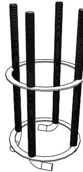
Fig. 1: Ancrage préfabriqué.
