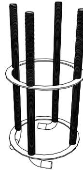
Fig. 1 : Ancrage préfabriqué
